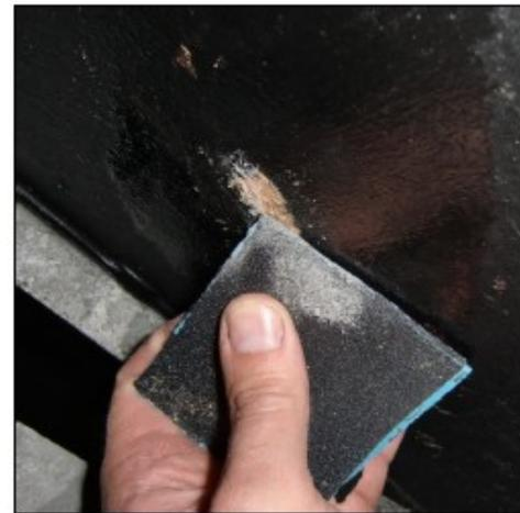
Nach der Beseitigung von Schleifstaub, z.B. mit einem feuchten Tuch oder Silikonentferner und anschließend gründlicher Trocknung, kann jetzt der schwarze Caravan Unterbodenschutz aufgetragen werden.
