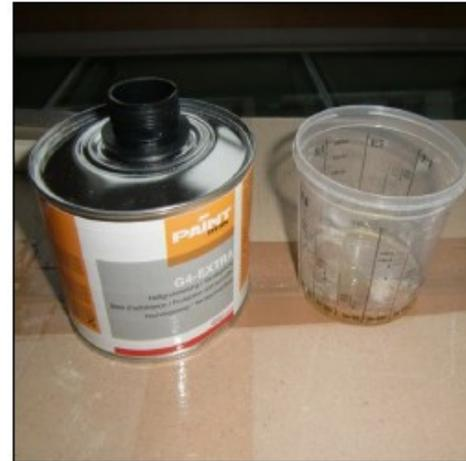
„G4“ ist ein unter Feuchtigkeitseinfluss aushärtendes Harz. Das Harz wird mit dem Sägemehl so vermischt, dass eine streichfähige nicht tropfende Masse entsteht.
